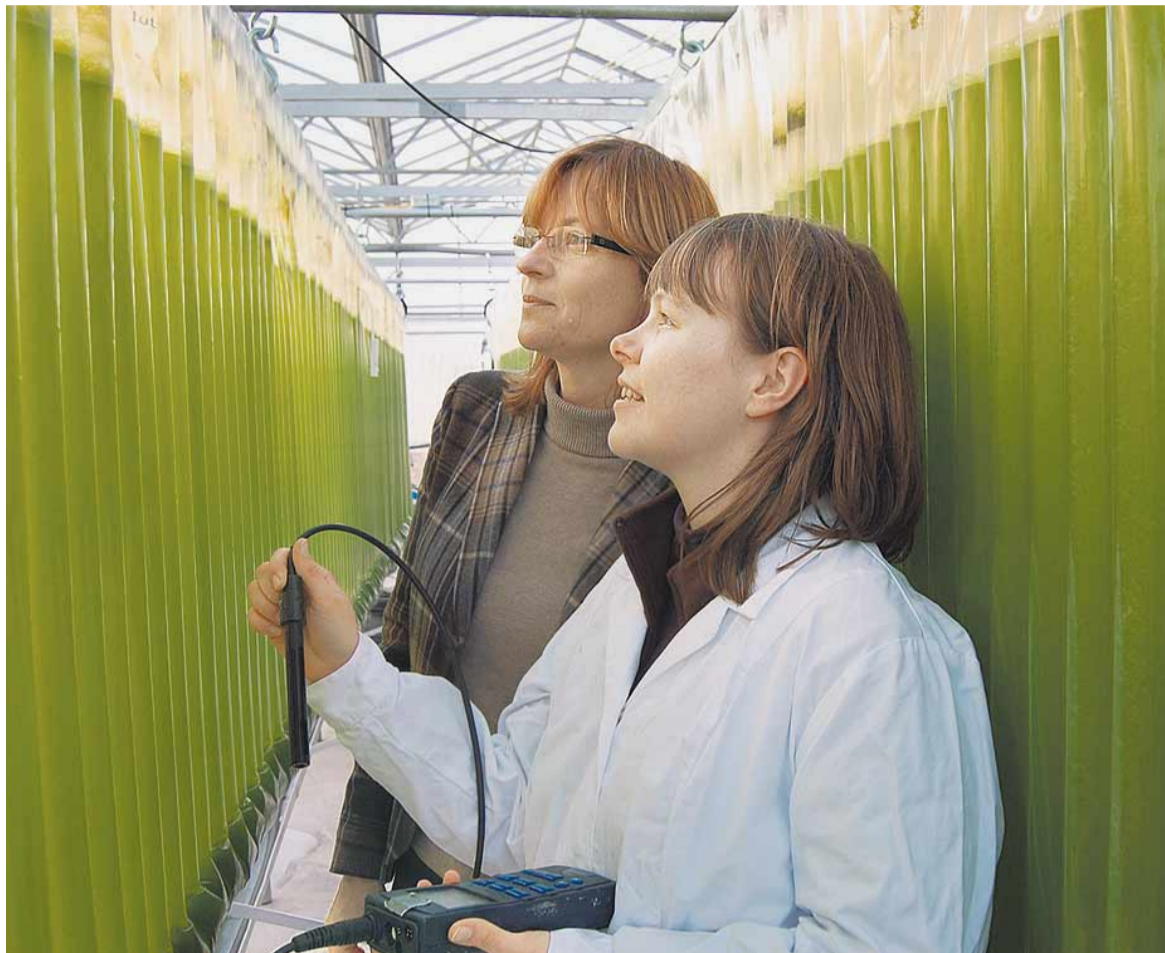
Neben dem Gelände des Heizkraftwerks in Bremen-Blumenthal kultiviert das Startup Phytolutions Mikroalgen in Kunststoffschläuchen. Die Algen wandeln CO 2 aus den Rauchgasen in Biomasse um
