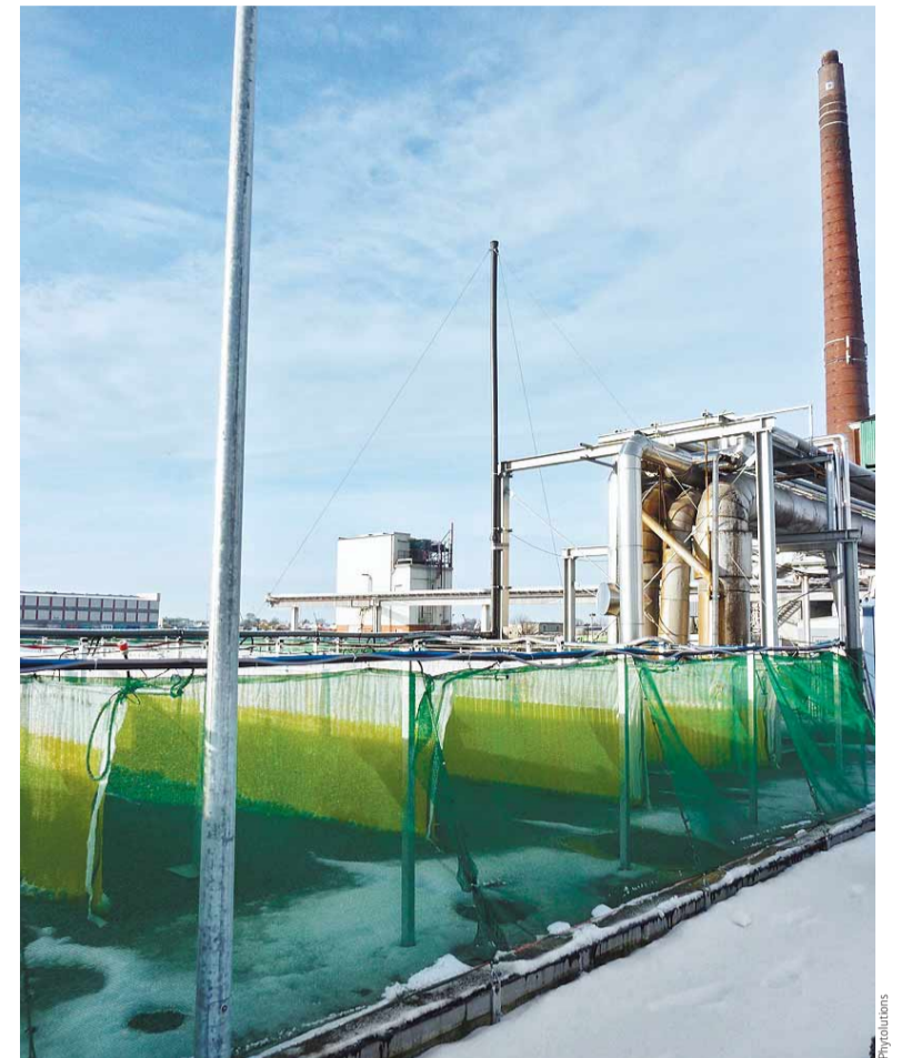
Neben dem Gelände des Heizkraftwerks in Bremen-Blumenthal kultiviert das Startup Phytolutions Mikroalgen in Kunststoffschläuchen. Die Algen wandeln CO 2 aus den Rauchgasen in Biomasse um
